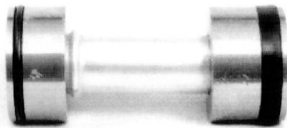
Figura 30 – Conjunto montado das tampas de vedação com o tubo, após a realização de um ensaio.
